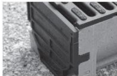
Clip B links en rechts met een mesje afsnijden. De eindplaat vastklikken
